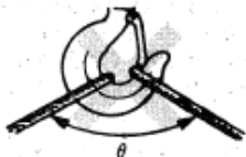
For vid vinkel på lasten. Skal være maks 60°
